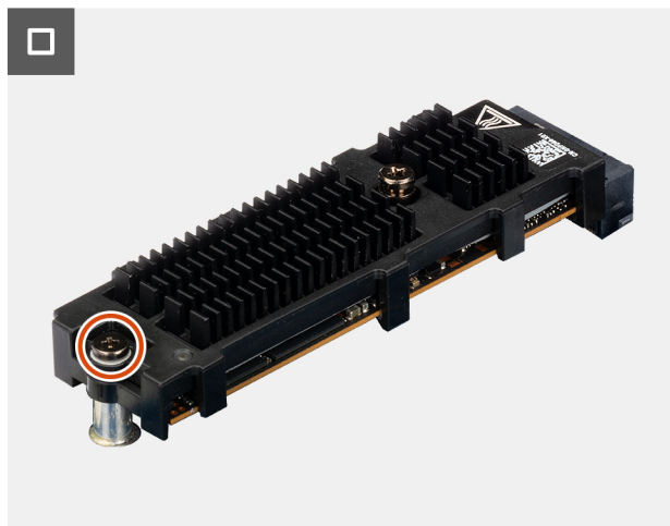
Abbildung 22. Einbauen des M.2-2280-PCIe-SSD-Laufwerks (Steckplatz 1)
